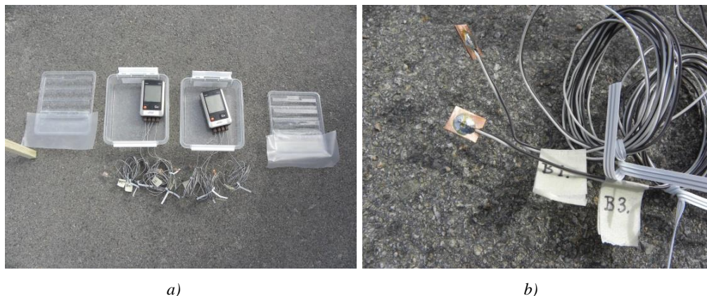
Figur 13 Visar mätinstrumentens utformning och a) visar loggarna och dess skyddande låda och b) visar termoelementens utformning och markering.
