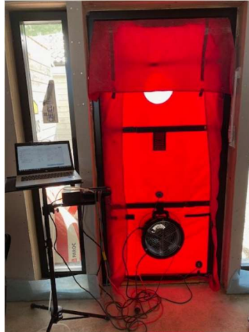
Figur 1 Blower door. (Foto taget av Ulf Lidberg, Conservator, 2023-04-13. Publicerad med godkännande från upphovsrättsägare.)
